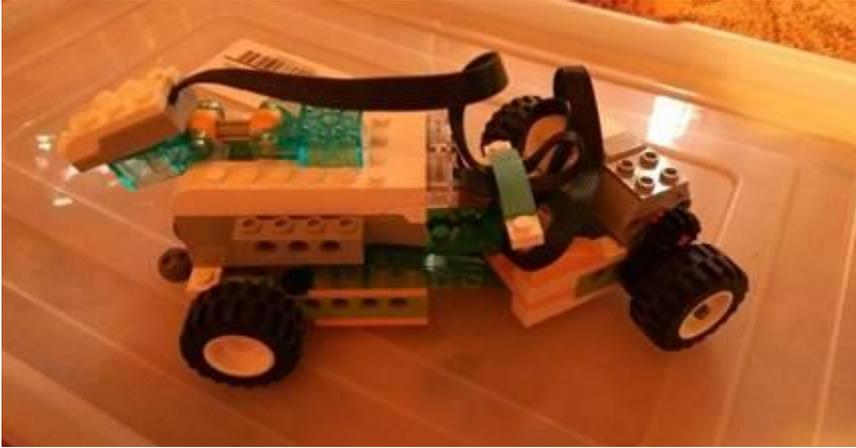
Нужно лишь вернуть модели разные оси и написать программу, в которой специальный блок будет снимать показания датчика движения и менять направление вращения мотора, чтобы машинка могла отъехать назад с разворотом и двинуться вперёд уже в другом направлении. И так до тех пор, пока не найдется выход:
