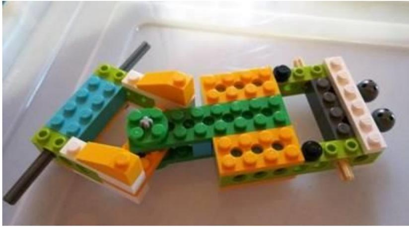
Ещё один интересный момент – установка блокировки поворота в одну сторону, чтобы машина при разных направлениях вращения мотора либо ехала вперёд, либо назад с поворотом направо.
